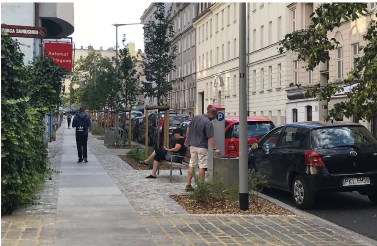
Obustronny pas kompensacyjny, poszerzony od strony jezdni, by w jego przestrzeni umieścić zieleni, miejsca odpoczynku, kosze na śmieci, stojaki rowerowe i latarnie. Zjazd na posesję z kostki rzędowej z zachowaniem ciągłości chodnika.
