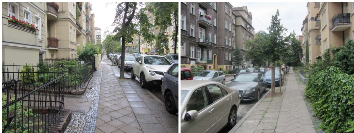
Ulica Poplińskich na Wildzie. Zachowany oryginalny chodnik: po stronie zachodniej z płytek 35x35 cm i połówkowych przy krawędziach a po stronie wschodniej z płytek 25x25 cm oraz z płytek typu czapka biskupia (infuła) przy krawędziach chodnika.
